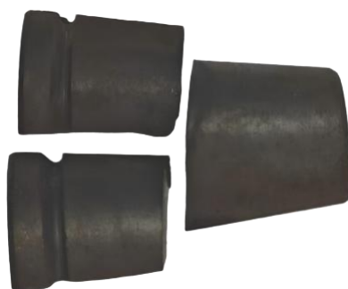
图K.2 夹片金相试件切割制备图片
