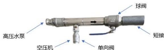
图3 射流器结构
