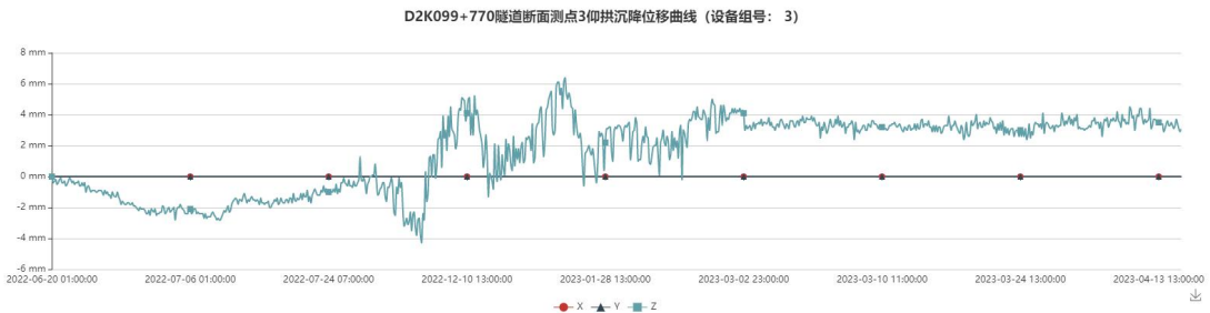
D2K099+770 隧道断面 03 测点仰拱沉降曲线图
