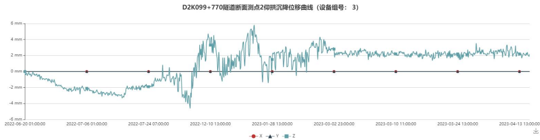
D2K099+770 隧道断面 02 测点仰拱沉降曲线图
