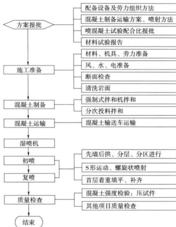
图 8.5.5 喷射混凝土施工工序
