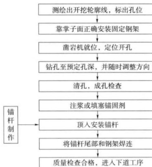
图 7.3.2 超前锚杆支护施工工序
