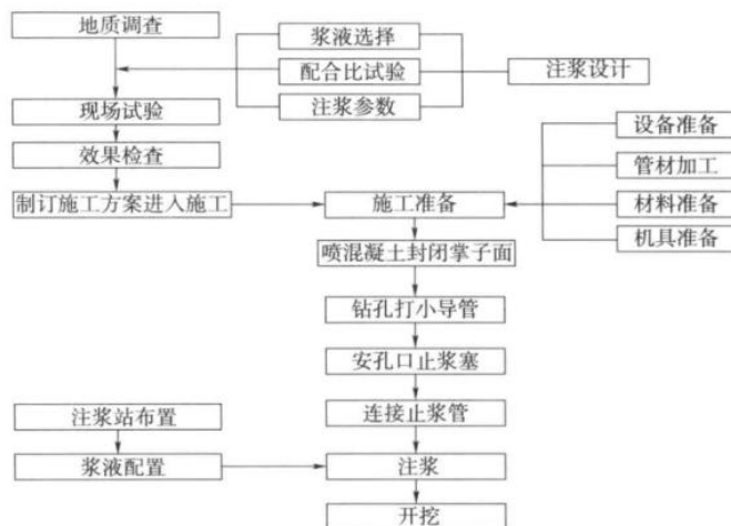
图 7.4.2 超前小导管支护施工工序
