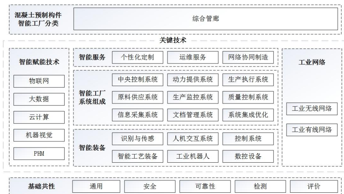
图 1 综合管廊智能工厂的结构组成
