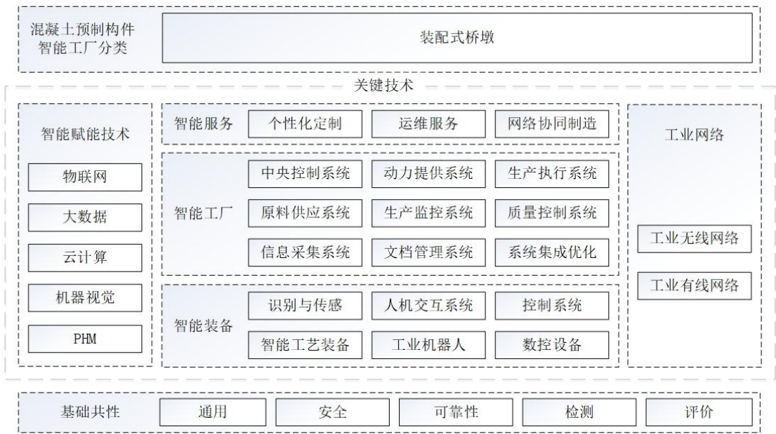
图 1 装配式桥墩智能工厂的结构组成
