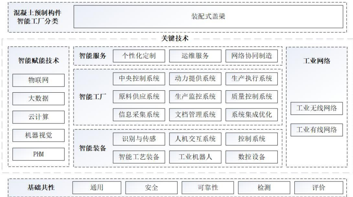
图 1 装配式盖梁智能工厂的结构组成
