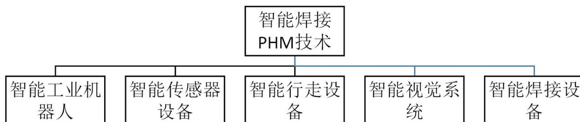
图 1 智能焊接 PHM 技术构成
